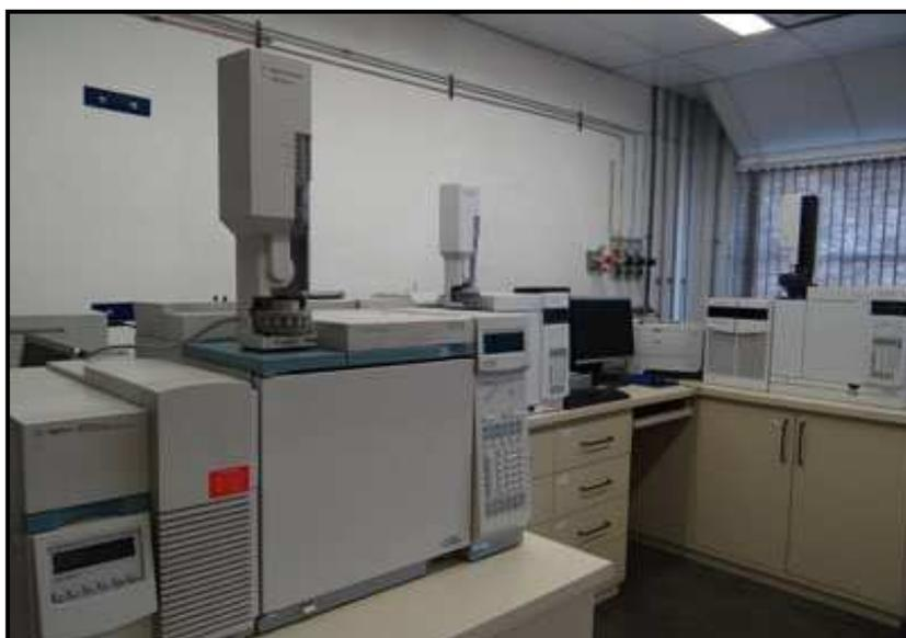
Legenda: Através das técnicas CG/EM e CG-EM/EM é possível identificar compostos moleculares com massas específicas gerando dados precisos para a caracterização da fração solúvel da matéria orgânica.
