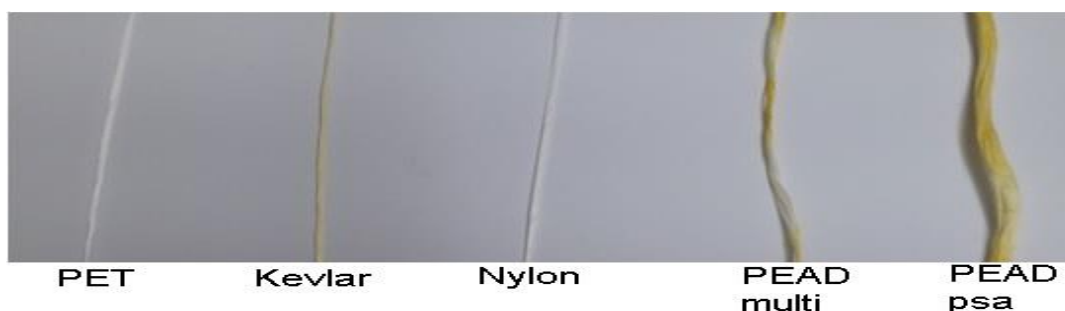
Figura 25 – Fibras comerciais utilizadas para teste de tração pela norma ASTM E 885
