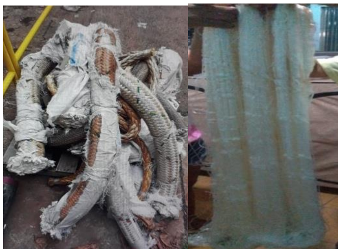
Figura 22 – Fotos do cabo de ancoragem usados durante sua desconstrução para extração das fibras de poliéster
