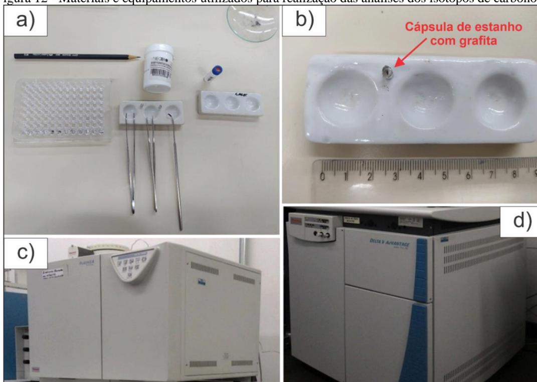
Legenda: A) Materiais utilizados para acondicionar as amostras na cápsula de estanho. B) Amostra de grafita acondicionada em cápsula de estanho. C) Analisador elementar Flash EA-1112. D) Espectrômetro de massa DELTA V Advantage.
