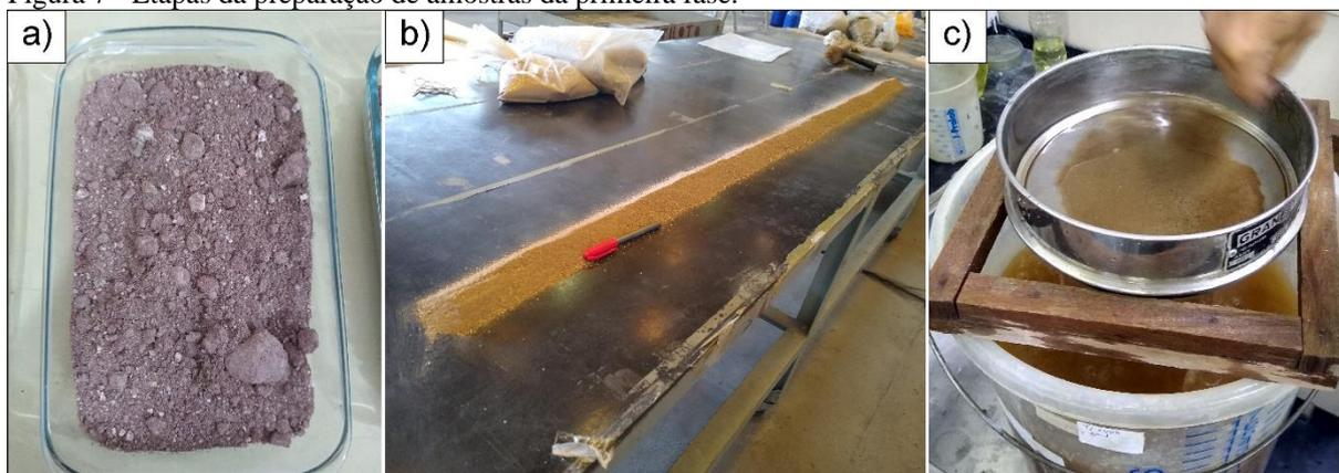
Legenda: A) Amostra selecionada para desagregação manual, observar o alto grau de alteração da rocha, formando solo muito argiloso e com alguns torrões de fácil desagregação; B) Procedimento de pilha de homogeneização; C) Deslamagem da amostra utilizando água e peneira de 0,044 mm.
