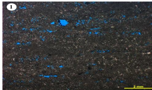
Figura 51 – Mudstone crenulado com Bioclasto – MdcB da Fm. Barra Velha, a esquerda imagem original com porosidade de 8,4%, a direita imagem binarizada, azul escuro representa os poros e o amarelo a matriz, porosidade estimada de 6,89%.
