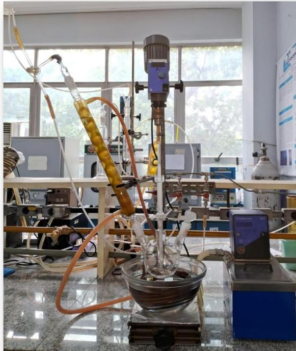
Nota: Banho termostaticado sobre um elevador. Sobre o banho, balão tritubulado fixado a uma haste com garra, acoplado a um condensador de bolas (por sua vez, associado a uma linha de nitrogênio) e a um mancal e um impelidor unidos a um agitador mecânico.
