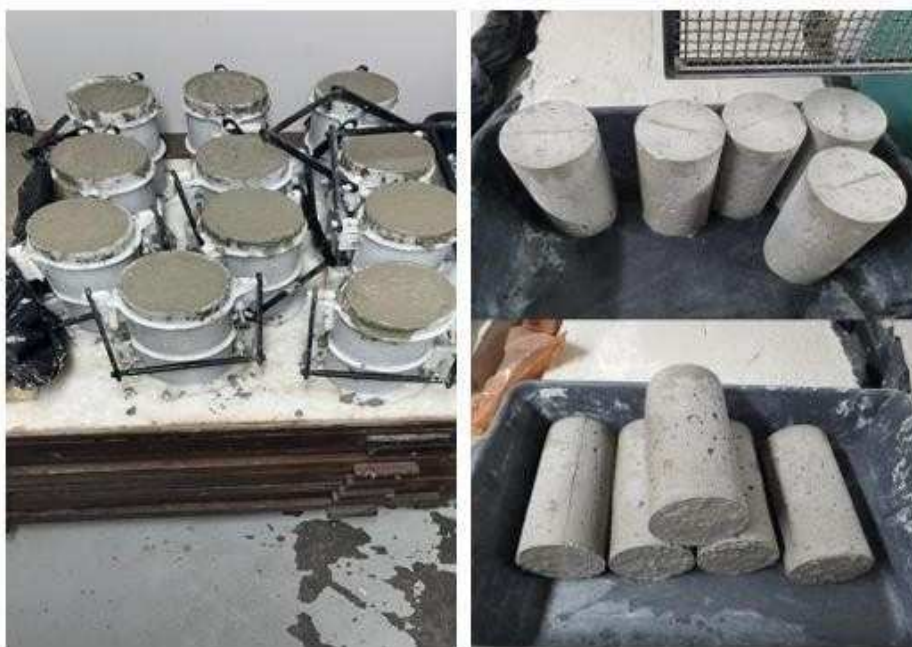
Figura 12 – Corpos de prova de 10 cm diâmetro e 20 cm de altura no molde e após a cura
