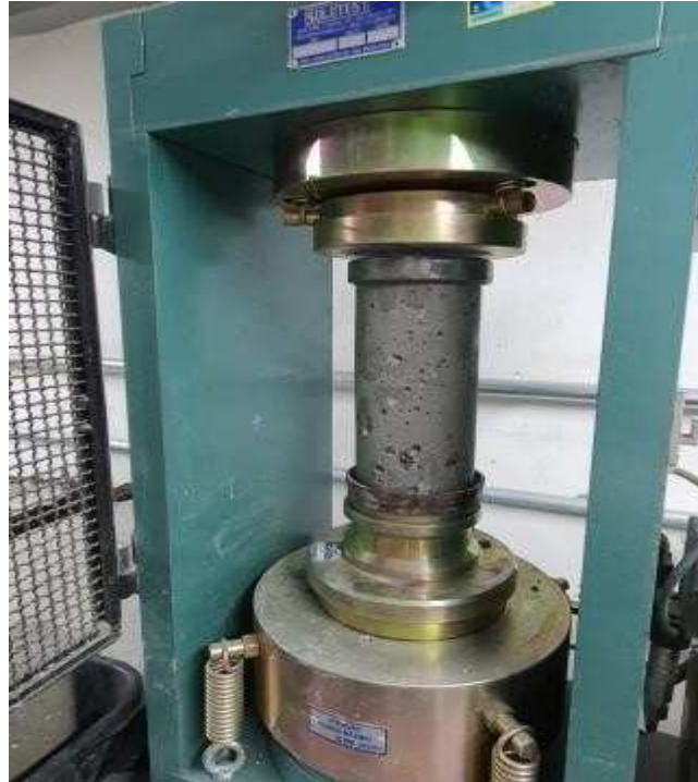
Figura 14 – Prensa Solotest (ensaio de compressão)
