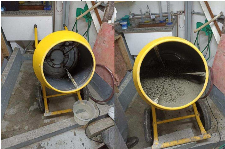
Figura 11 – Betoneira utilizada na manipulação do concreto
