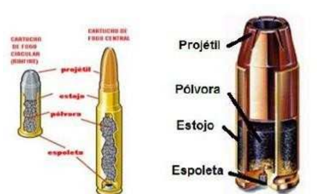
Figura 4 – Composição do cartucho de calibre nominal 7,62” e 0,40”:
