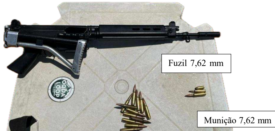
Figura 16 – Arma e munição utilizada no ensaio balístico
