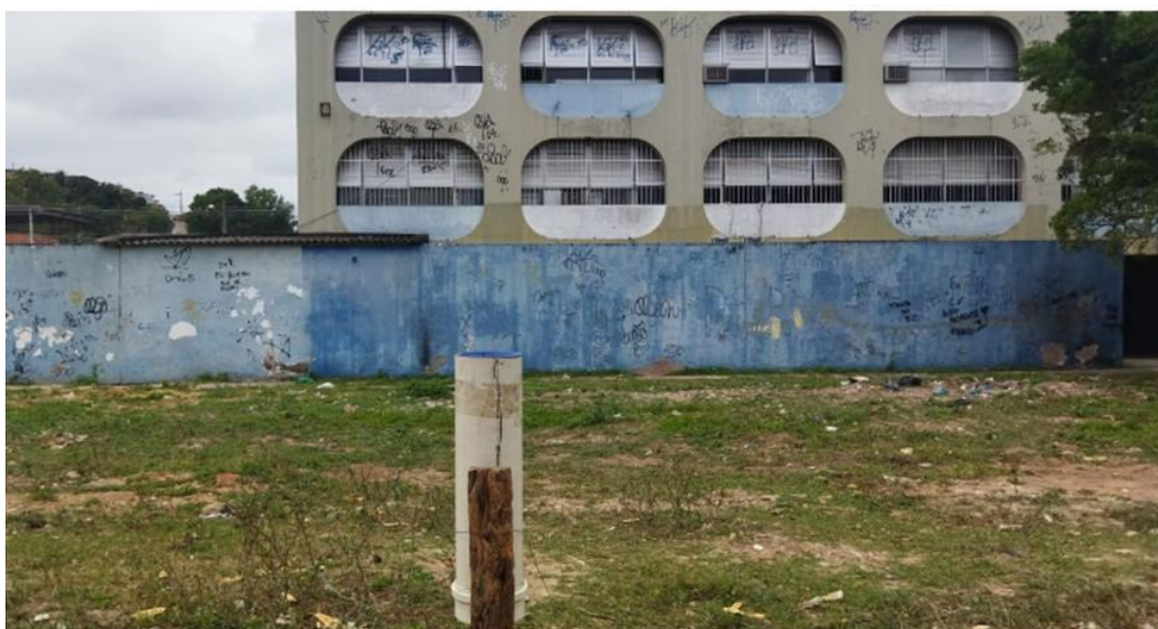
FIGURA 32. PLUVIÔMETRO INSTALADO NO CIEP JOSUÉ DE CASTRO 029
