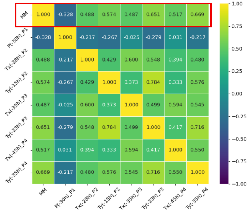
Figura 23 - Mapa de correlação de Pearson entre a MM e as variáveis meteorológicas selecionadas (pressão atmosférica no ponto P1 e tensões do vento Tx e Ty nos pontos P2, P3 e P4), considerando as respectivas defasagens temporais.
