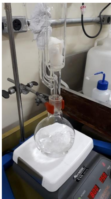
Figura 10 - Aparato Soxhlet montado para extração do surfactante do gel obtido
