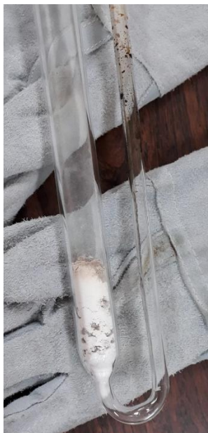
Figura 11 - Reator de vidro em U usado para tratamento térmico dos sólidos
