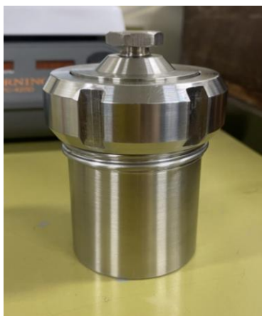
Figura 8 - Autoclave fechada usada na síntese
