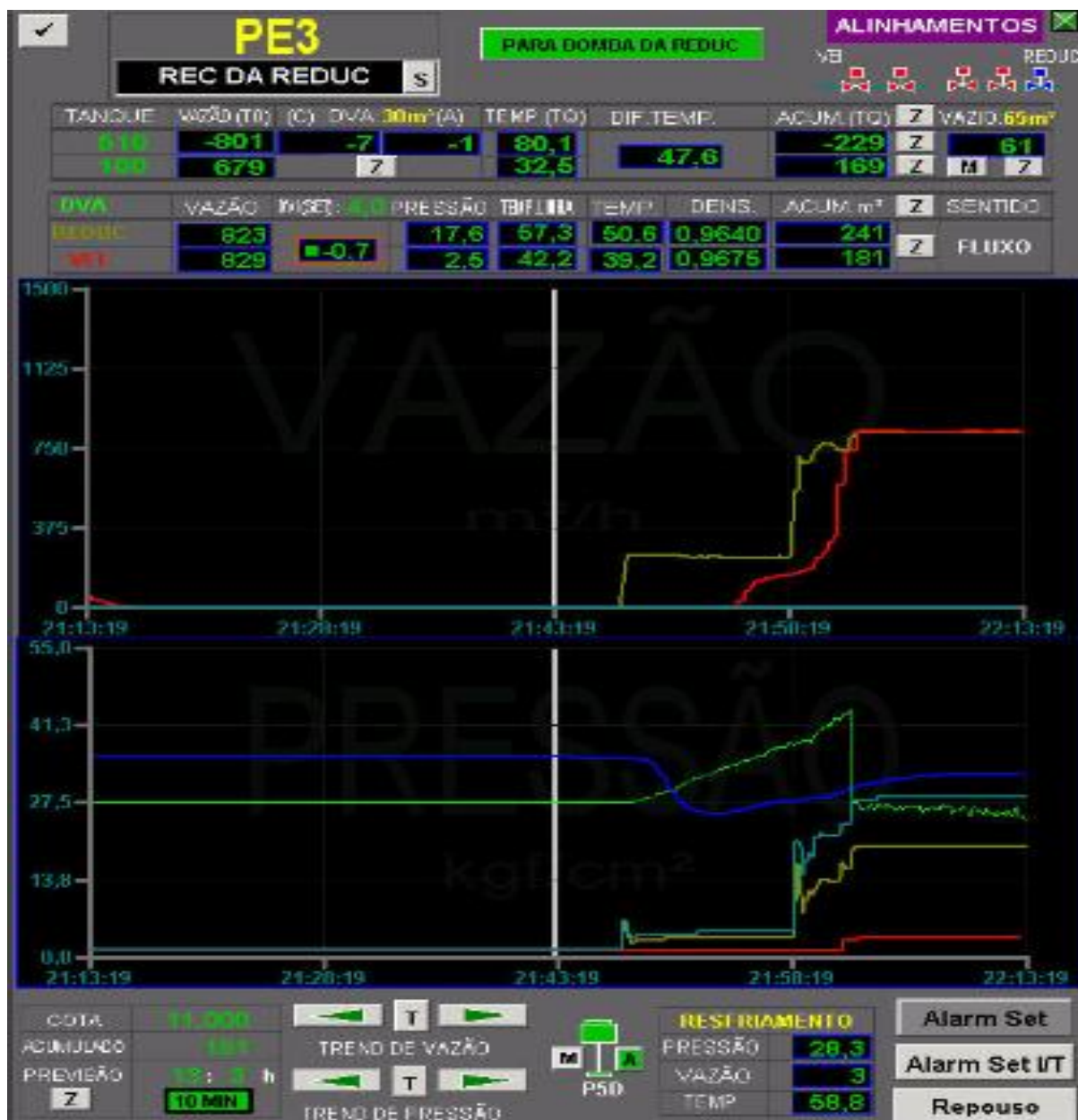
Figura 45 - Monitoramento da transferência da REDUC para ID em início de operação
