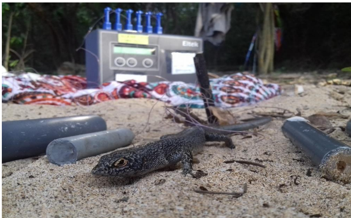
Figura 17 – Calibração de diferentes modelos de PVC para seleção do mais apropriado para reproduzir a temperatura operativa ambiental de Trachylepis atlantica
