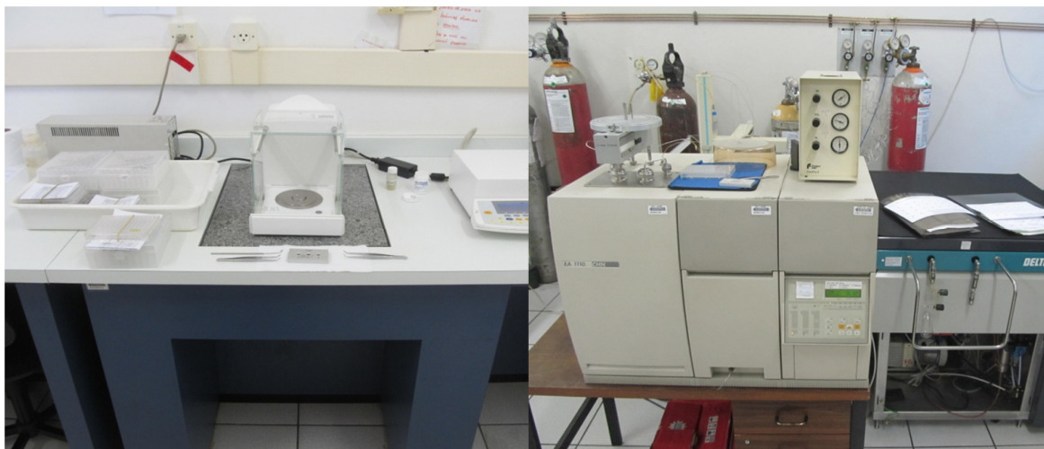
Figura 10 - Laboratórios do o Centro de Energia Nuclear na Agricultura da Escola Superior de Agricultura Luiz de Queiroz, Universidade de São Paulo (CENA-USP). À esquerda, bancada para encapsulamento e pesagem das amostras para análise isotópica. À direita, espectrômetro de massas. Fotos: Lima, V.N.
