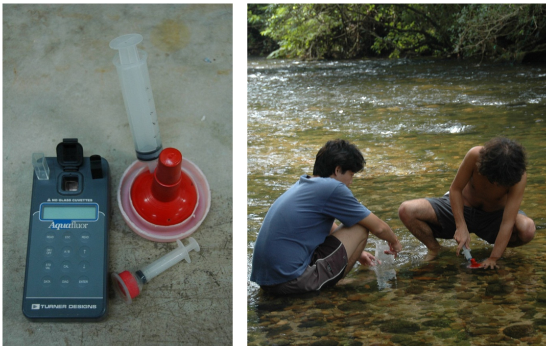
Figura 11 - Coleta e materiais de preparação do perifíton. A esquerda, Fluorômetro Aquafluor 8000 (Turner Designs, Sunnyvale, CA, EUA) e o amostrador de perifíton. Foto: Sato, C.Y.S.; A direita, coleta de perifíton. Foto: Moulton, T.P.
