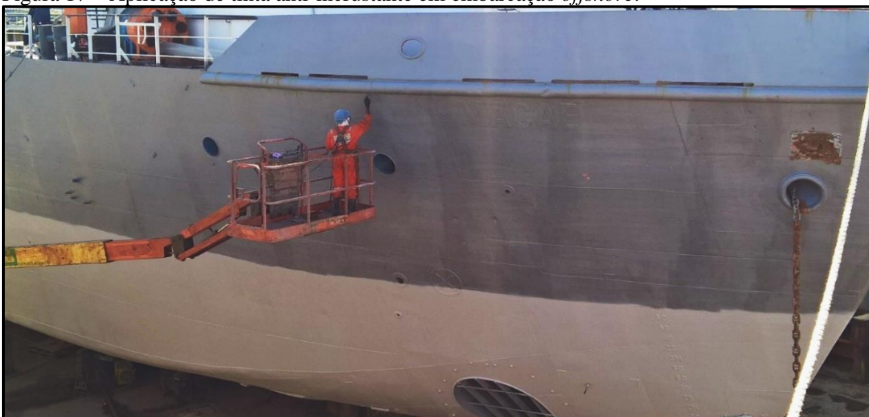
Figura 17 – Aplicação de tinta anti-incrustante em embarcação offshore .
