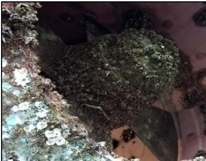
Figura 18 – Exemplos de bioinscrustação em hélices de propulsão de embarcações offshore .
