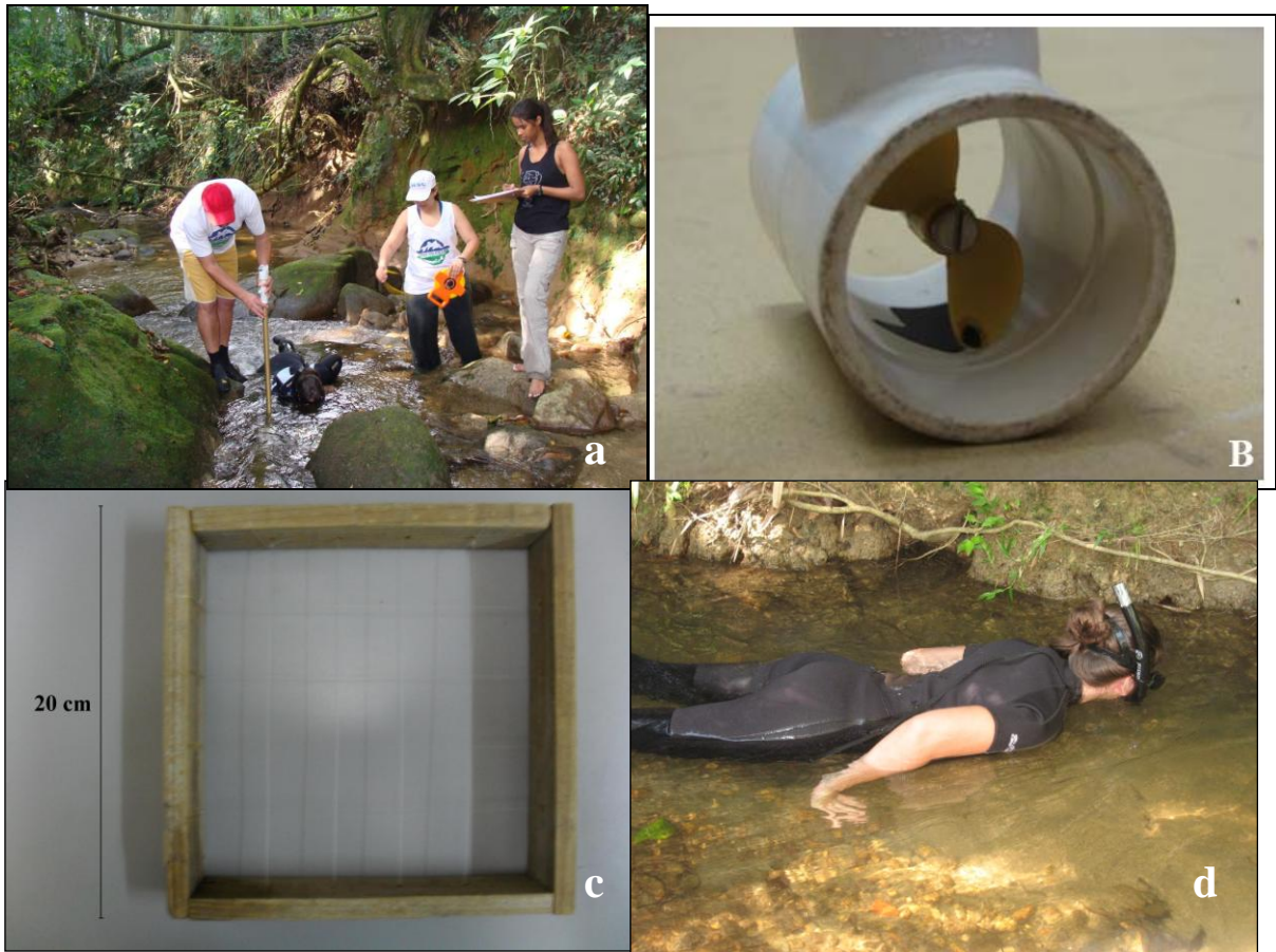
Figura 21 - Técnicas de amostragem no local de estudo do Rio Roncador, Saquarema – RJ. Legenda: (a) Coletas dos dados de uso do micro-hábitat com o auxílio de um fluxômetro e trena de 50 metros; (b) Detalhe do fluxômetro; (c) Quadrat de 20x20cm utilizado para quantificar o tipo de substrato no leito do riacho; (d) Observação subaquática. Fotos: Piatã Santana Marques.
