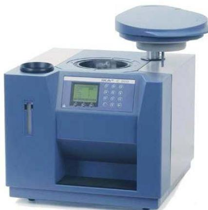
Figura 6 - Calorímetro Ika 200 utilizado na queima das amostras.
