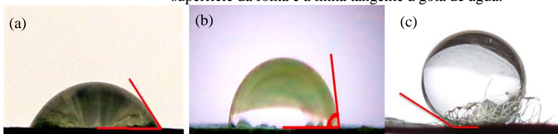
Figura 2 - Repelência hídrica foliar medida como o ângulo de contato entre a superfície da folha e a linha tangente à gota de água.
