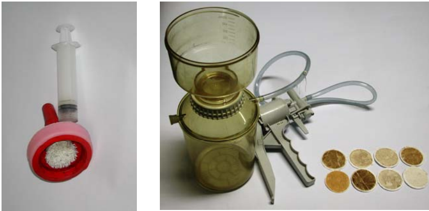
Figura 8 - Fotografia do amostrador de Perifiton (Loeb 1981) e material de filtragem formado pelo suporte e bomba de sucção junto com os filtros de sílica.
