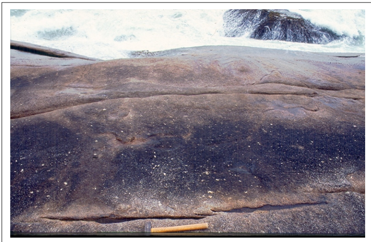
FIGURA 5.43 - Fraturas NE en echelon em rocha charnockítica do costão da Ilha Grande, RJ.
