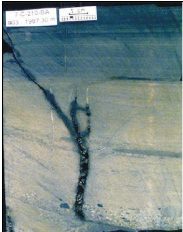
Figura 19 - Fratura preenchida por óleo em folhelho da Fm. Candeias, Bacia do Recôncavo Fonte: Destro (2002)
