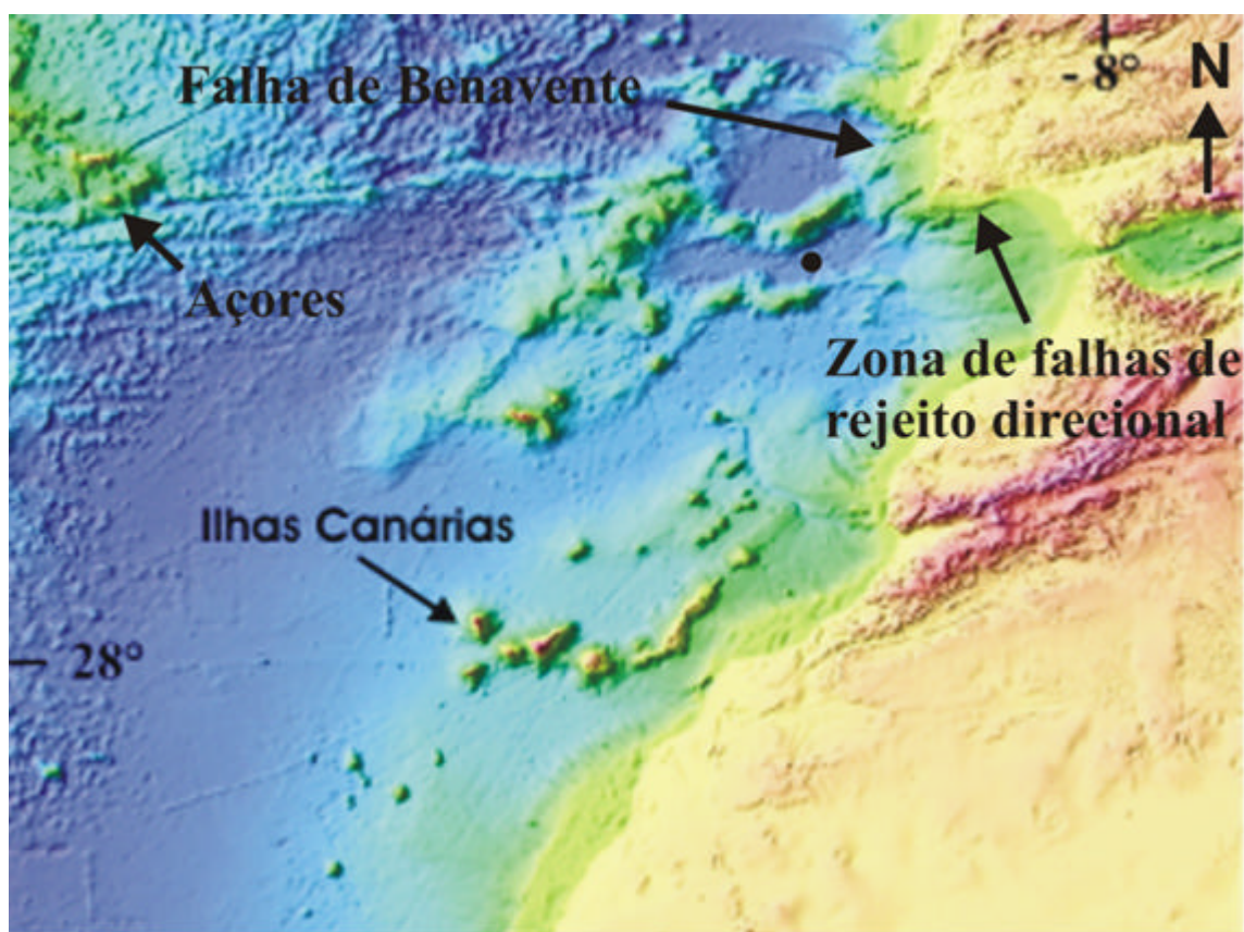
Figura 24 – Mapa de localização do Arquipélago das Canárias, baseado em altimetria de satélite. Observar que o referido arquipélago está situado na intersecção entre zonas de falhamentos de direções SW-NE (paralelos à linha de costa do continente africano) e E-W (prolongamentos das falhas transformantes da Cadeia Mesoatlântica). Os montes vulcânicos submarinos estão alinhados de acordo com as principais zonas de falhas. O ponto negro mostra a provável localização do epicentro do grande terremoto de Lisboa, ocorrido em 1755, segundo o site http://pt.wikipedia.org/wiki/Terramoto_de_Lisboa . (Mapa de Sandwell e Smith, 1997).
