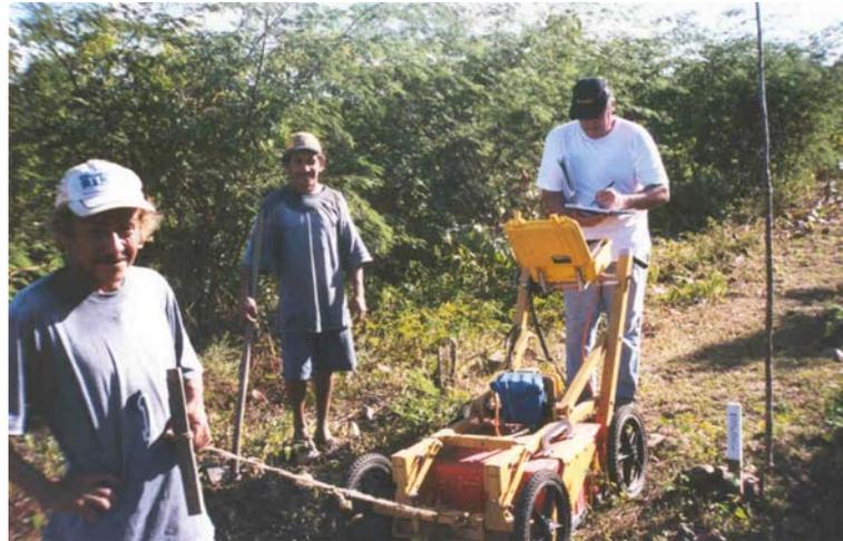
Figura 2 - Equipamento de IDS-Radar RIS Multifrequencial em Aracoiába
