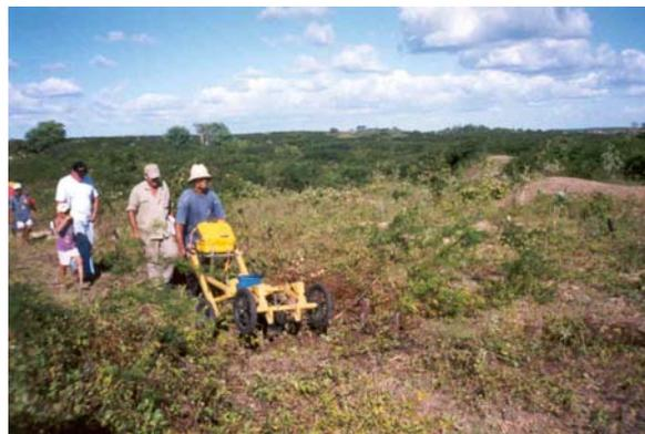
Figuras 41 e 42 - Levantamentos de GPR realizados na Fazenda da Laje com Sistemas Ramac e com GPR IDS-Radar RIS Multifrequencial
