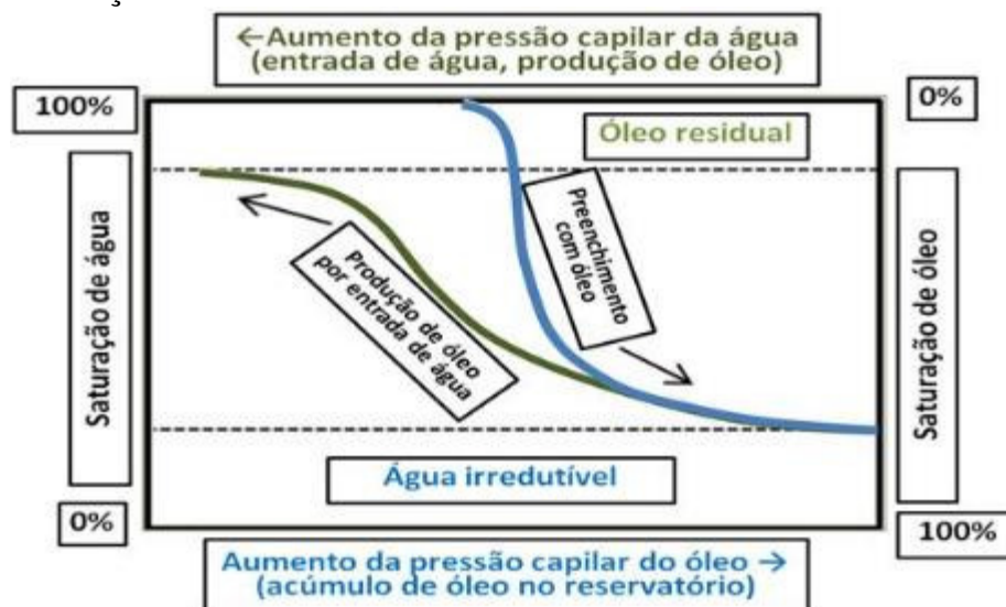
Figura 1 – Descrição das curvas de saturação de água e óleo durante a drenagem e imbibição
