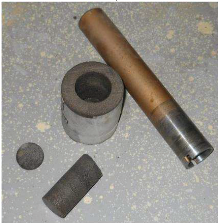
Figura 60 – Detalhe de ferramenta de corte para redimensionamento de plugues
