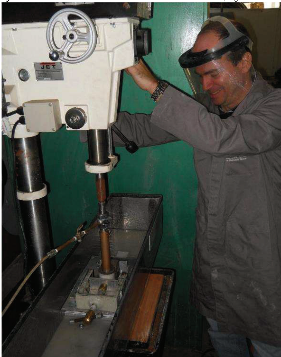
Figura 59 – Redimensionamento das amostras da FGEL com uma plugadeira
