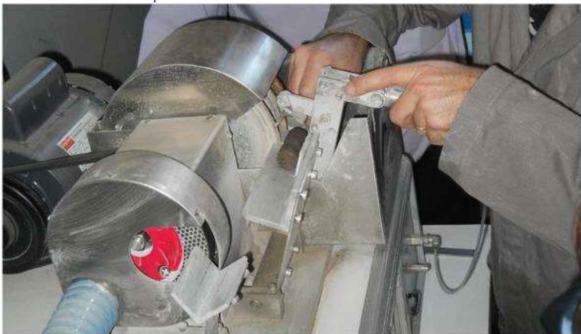
Figura 61 – Corte de plugues para assegurar uma face perfeitamente perpendicular ao seu comprimento
