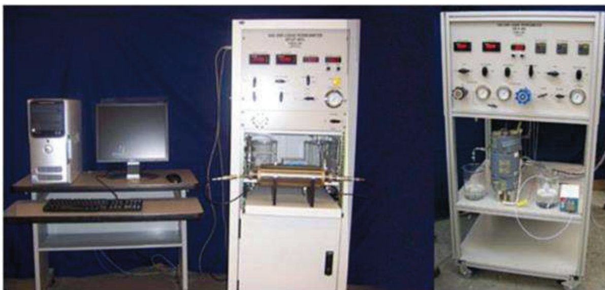
Figura 66 – Exemplo de permeômetro e sistema de controle e medição acoplado, da Core Laboratories
