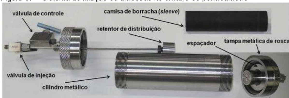
Figura 67 – Sistema de fixação de amostras no cilindro do permeâmetro
