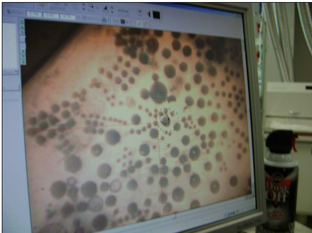
Figura 3.15 – Imagem do padrão internacional (zircão BR266), sendo utilizado para a calibração do equipamento. Notar a quantidade de “spots” decorrentes do constante uso deste padrão (foto tirada pelo autor durante as análises na University of Alberta, Canadá ).
