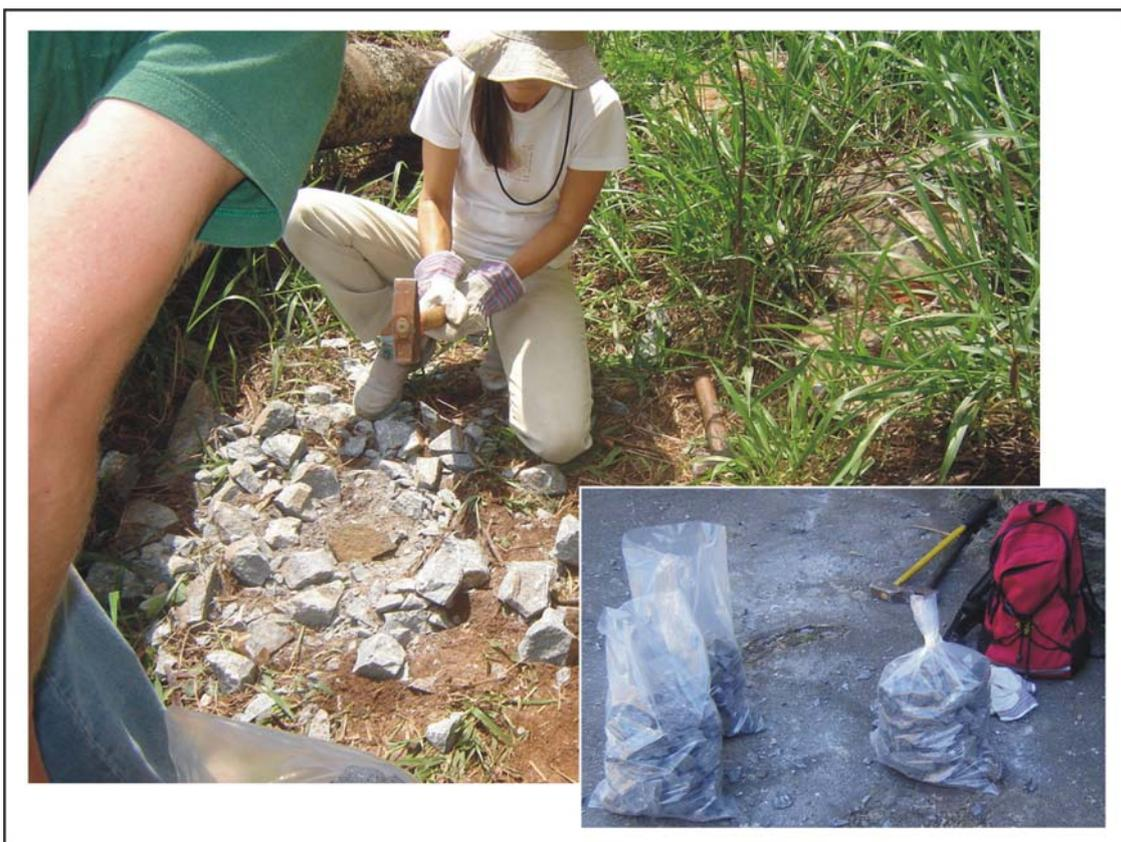
Figura 46 – Coleta de amostras (30 kg para rochas ácidas e 50 kg para rochas básicas).
