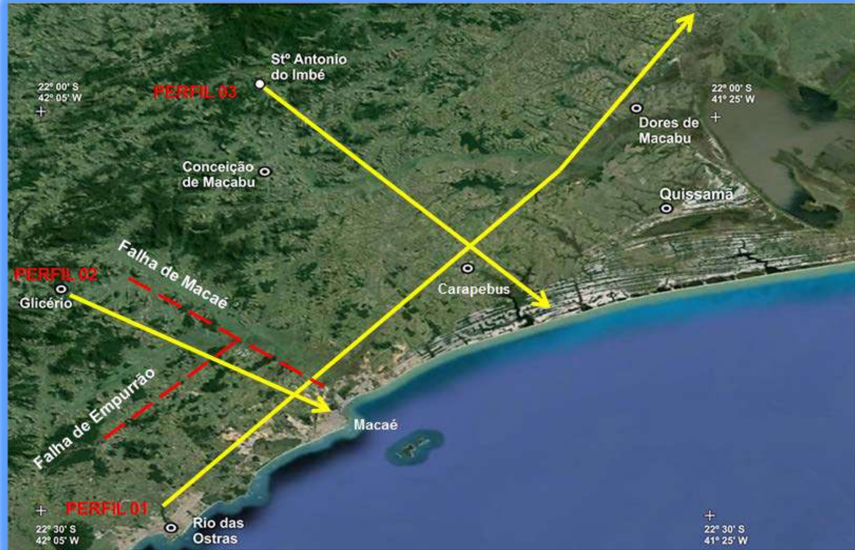
Figura 2 – Imagem do Google Earth da área de estudo com localização dos perfis e falhas na porção Onshore da Bacia de Campos.
