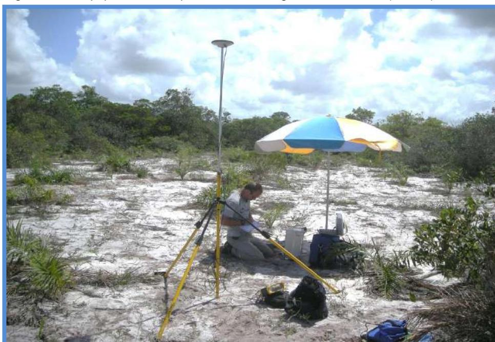
Nota: Equipamento TecGeo - GTR /G2 e gravímetros ao fundo durante a medição.
