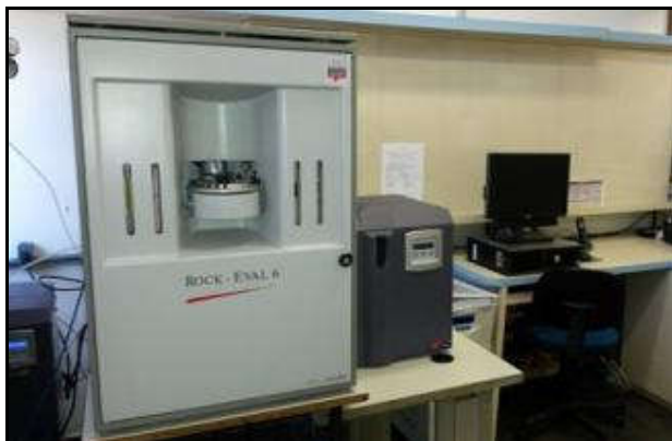
Figura 32 - Pirolisador Rock-Eval. 6 da marca Vinci Technologies, do LGQM-UERJ, utilizado nas análises de pirólise.
