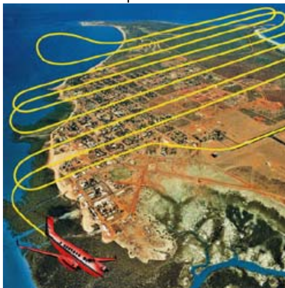
Figura 22 – Desenho esquemático sobre as linhas de voo. As mesmas são paralelas e com mesmo espaçamento (Libonatti, 2005)
