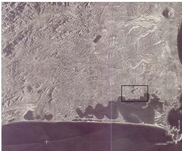
Figura 48 – Imagem de radar do projeto Radam utilizada na interpretação de lineamentos. Descobriu-se em campo que muitos dos lineamentos que eram vistos e interpretados como falhas, na verdade se tratavam de diques. No quadrado está a área de mapeamento detalhado – vide figura 49.
