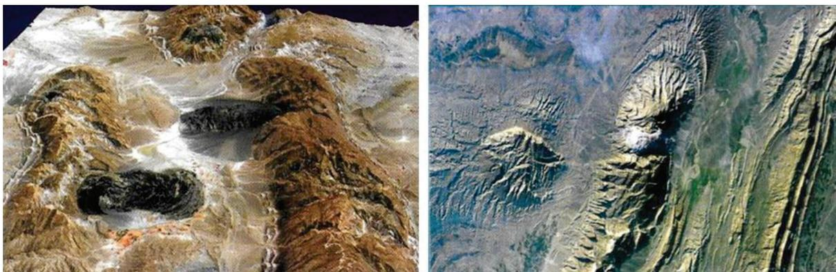
Legenda: A esquerda, visão em 3D de estruturas anticlinais, na região de Zagros, com extrusão de línguas de sal na superfície. A direita, imagem de satélite da Nasa mostrando o anticlinal de Kuh-I-Namak, na região do cinturão de dobramentos do Zagros, na parte sul do Irã.
