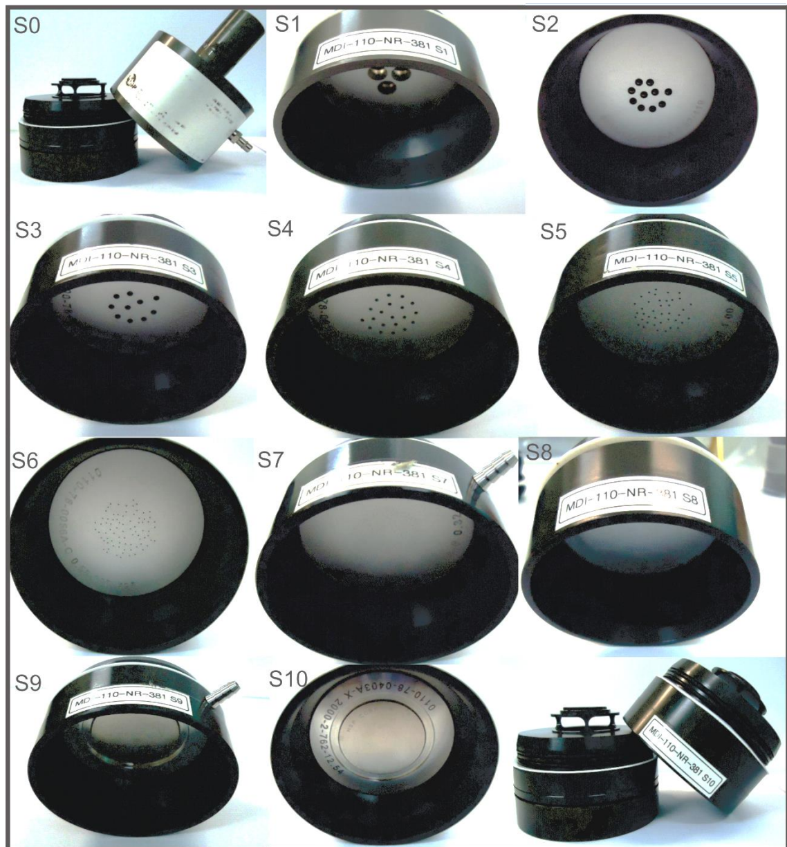
Figura 13 - Estágios de separação do MOUDI™.
