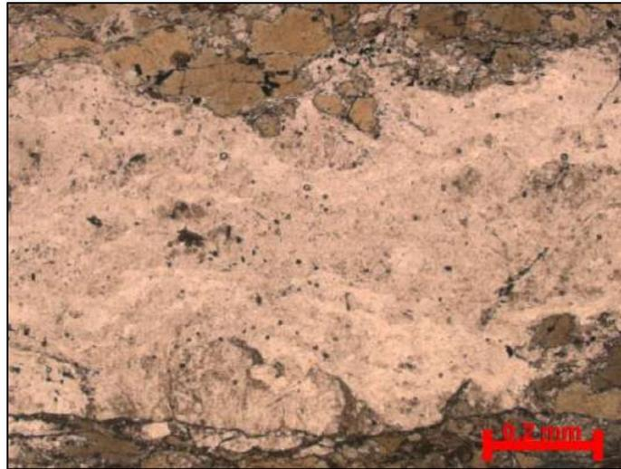
Legenda: Fotomicrográfica do bandamento composicional, com uma banda félsicas entre duas bandas máficas – NP (BM-364 C).
