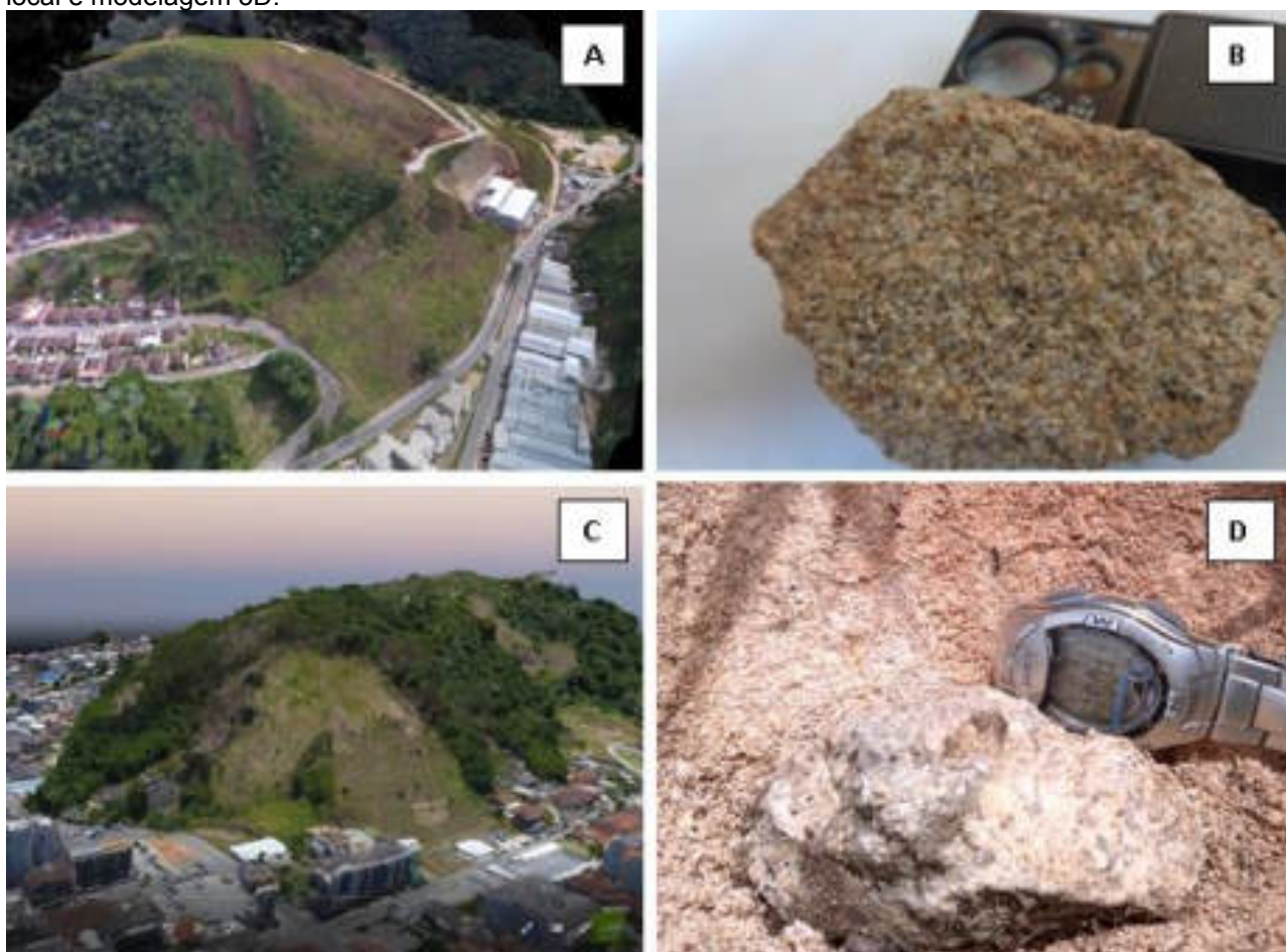
Figura 62 - Rupturas em solos profundos e morros circulares de alteração de rochas ígneas – Vistoria local e modelagem 3D.
