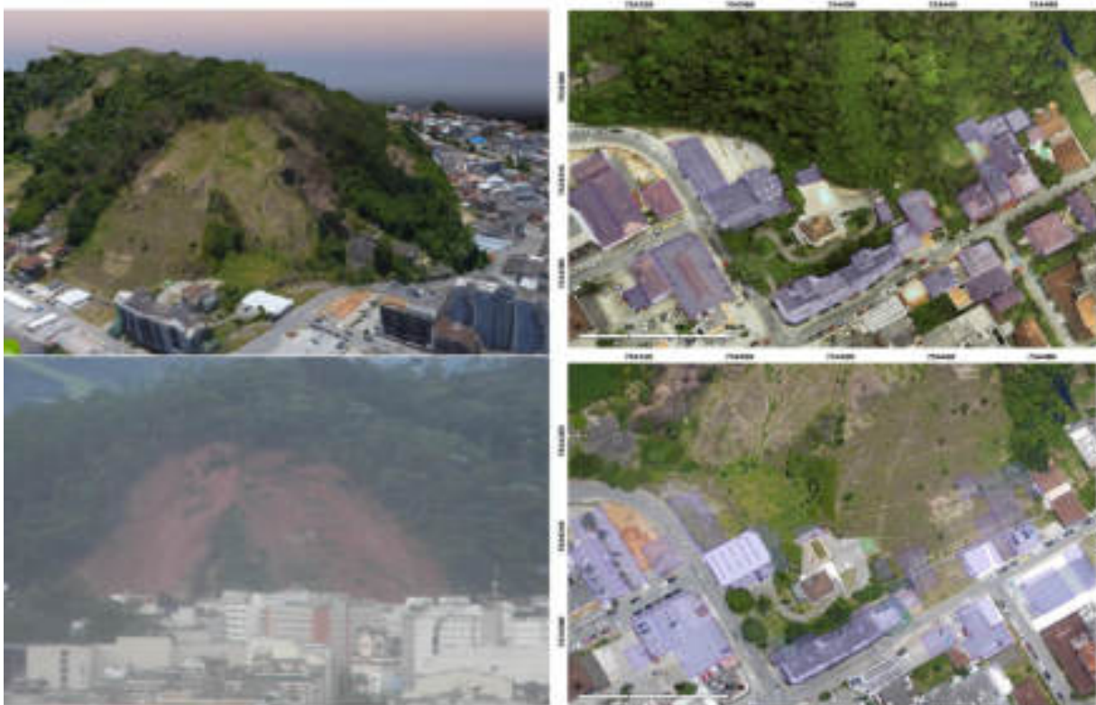
Figura 21 - Verificação 3D no Centro para deslizamento planar.
