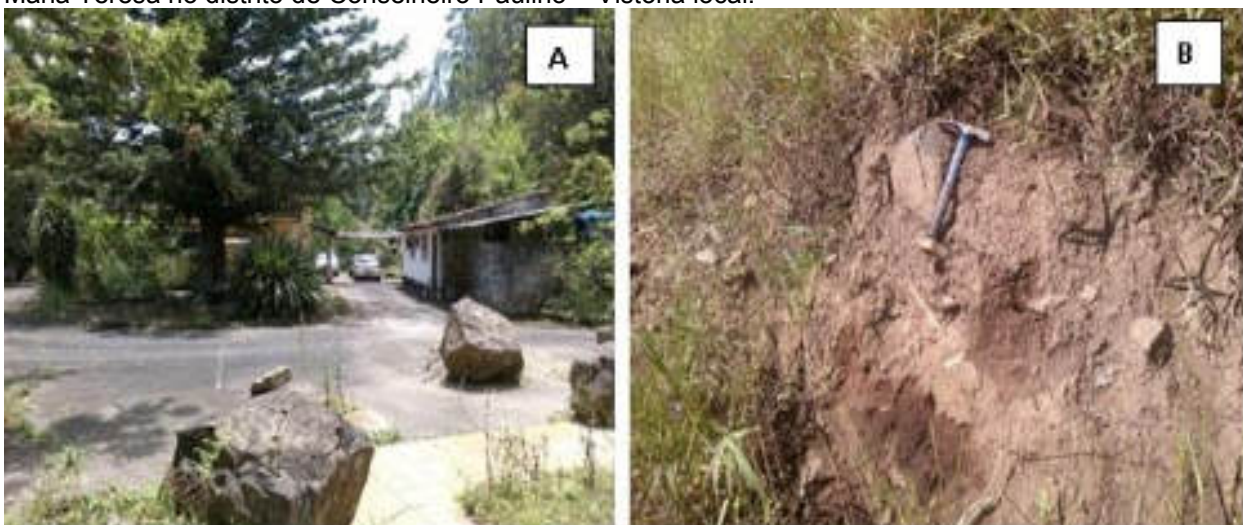
Figura 24 - Depósito de tálus localizado no Condomínio da Pedra, Vale dos Pinheiros (a) Depósitos de tálus localizado no bairro de Varginha, distrito Sede e (b) tálus no Vale das palmas no bairro de Maria Teresa no distrito de Conselheiro Paulino – Vistoria local.
