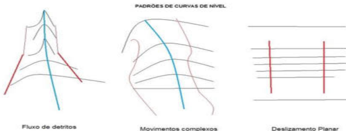
Figura 71 - Padrões de curvas de nível utilizado para definição preliminar das ocorrências de fluxos de detritos, movimentos complexos e deslizamentos planares.
