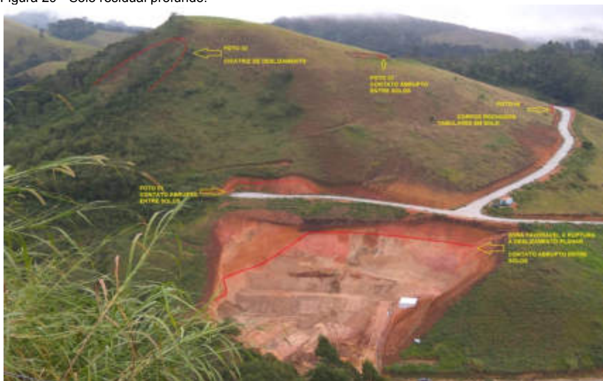
Figura 29 - Solo residual profundo.
