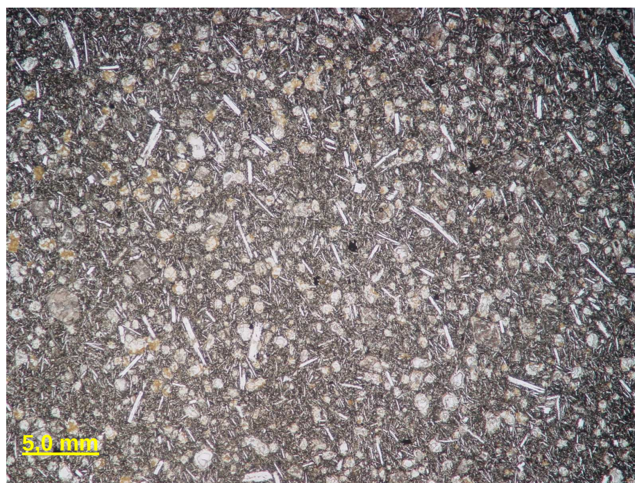
Figura 23 – Textura seriada com grãos de plagioclásio em forma de ripas e olivinas arredondadas orientados em dique de diabásio. Amostra SSE-RS-29. Nicóis paralelos.
