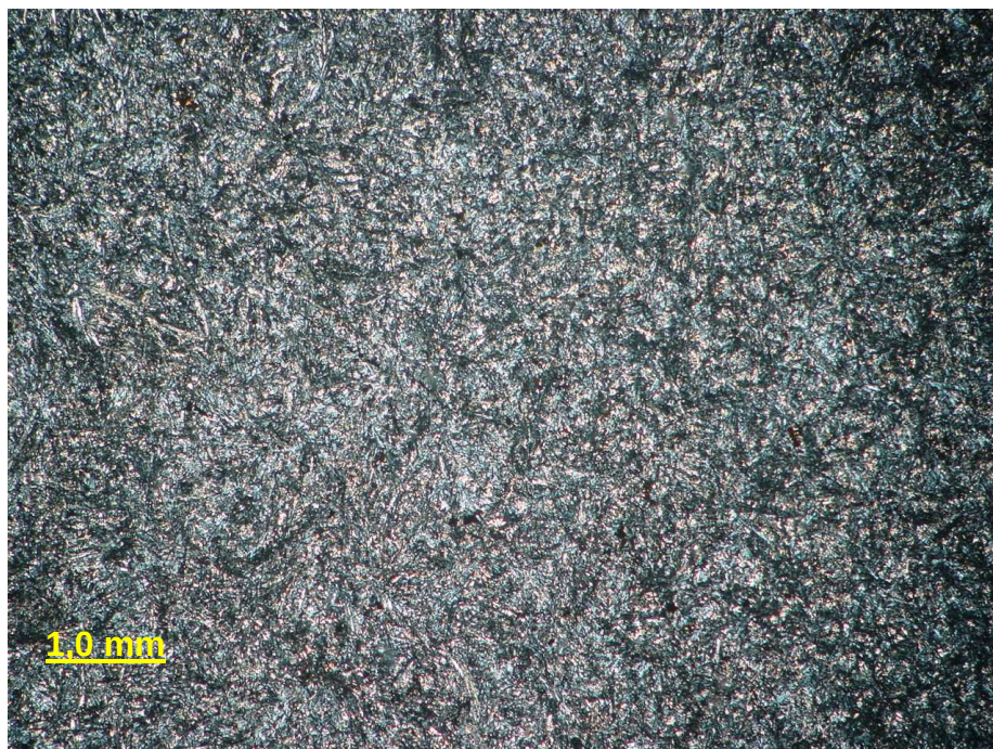
Figura 22 – Diabásio com granulação fina, com grãos de plagioclásio em forma de ripas e augita. Amostra UBA-RS-30D. Nicóis cruzados.
