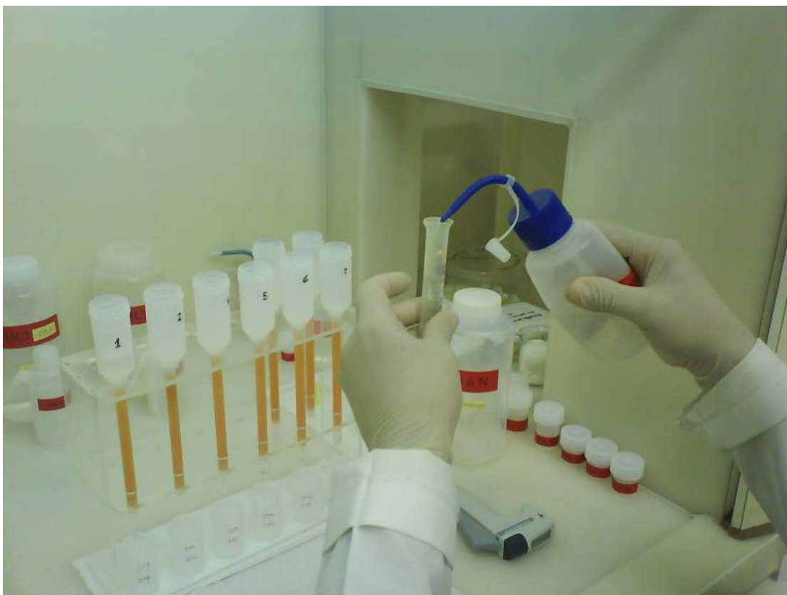
Figura 7 - Adição de 10mL de HCl 2,5M na coluna primária.
