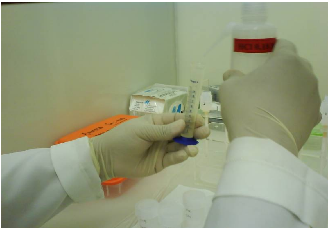
Figura 10 - Medição de 3mL de HCl 0,18M para ser colocado na coluna secundária.
