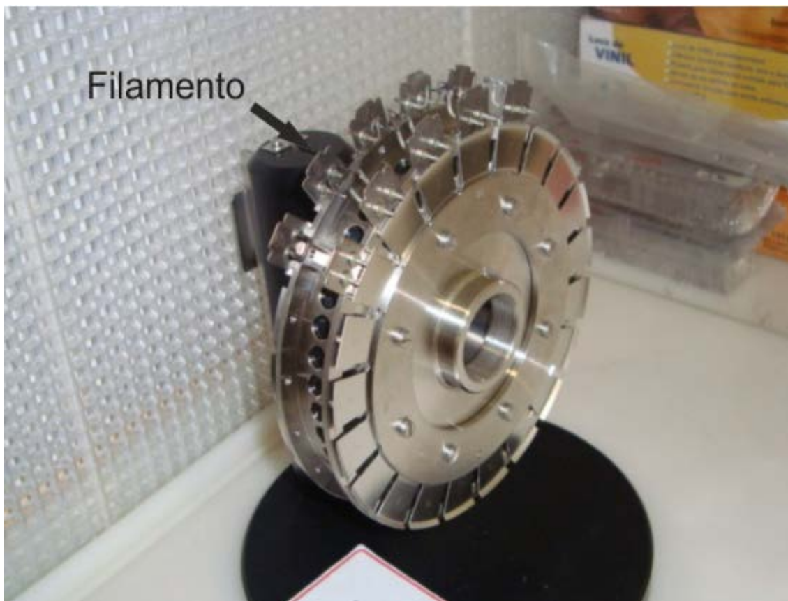
Figura 13 - Colocação dos filamentos no carrossel para análise no espectrômetro de massas.
