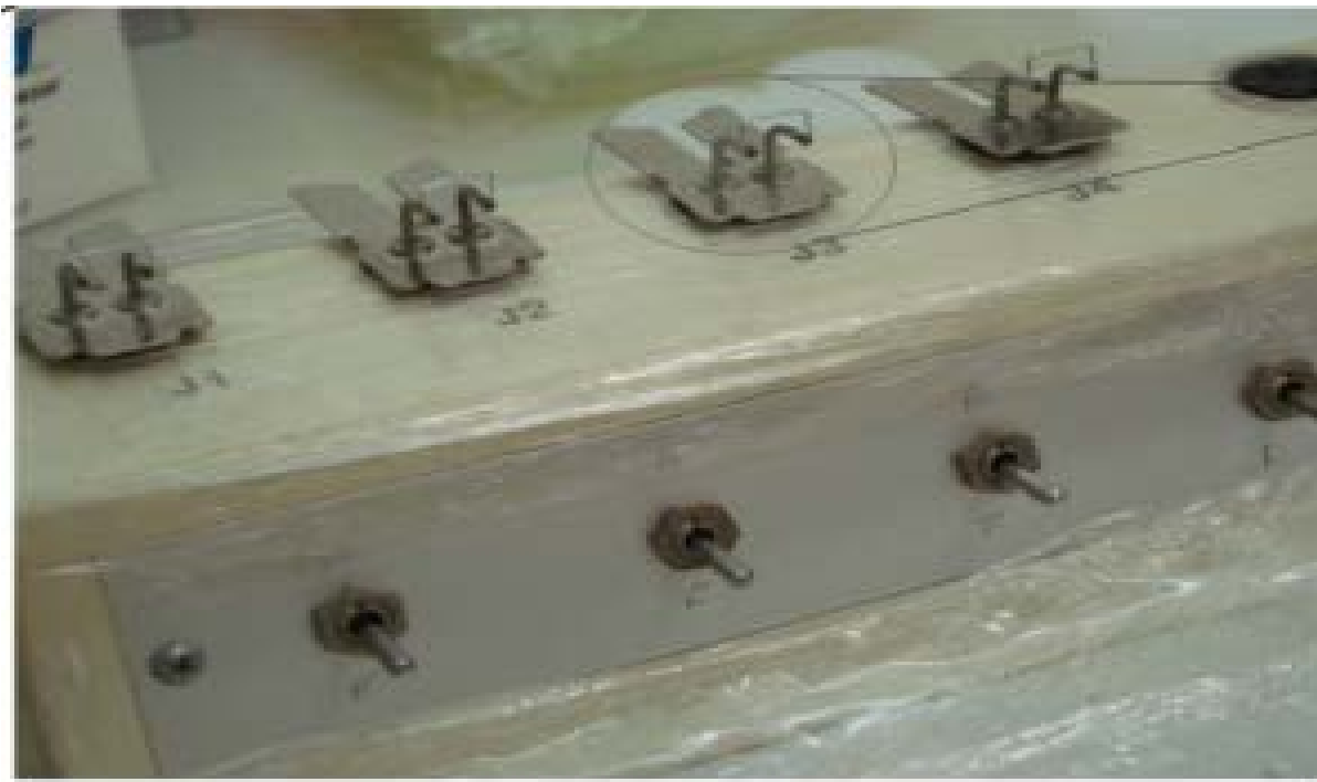
Figura 12 - Colocação dos filamentos no aparelho para depósito das amostras.
