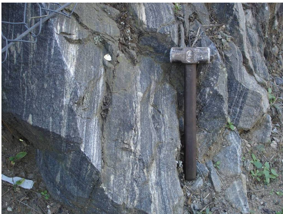
Figura 23 - Ponto TR-TM-71. Afloramento de biotita-ortogneiss com foliação subvertical do Complexo Quirino, na BR-040, Km 15 (vista de cima).
