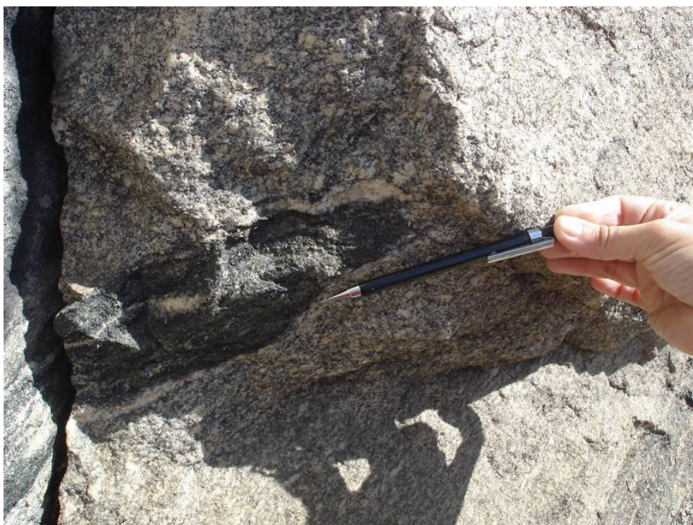
Figura 49 - Ponto PS-PM-66. Enclave piroxenítico em ortogneisse do Complexo Quirino (PS-PM-66B).
