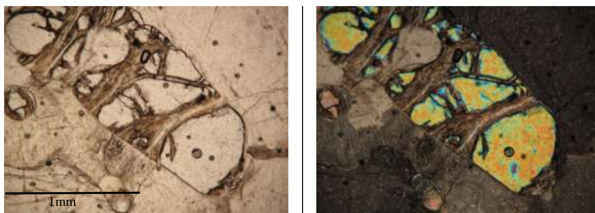
Figura 40 - Lâmina delgada: Olivina magnesianas com serpentinização na amostra de mármore SJU-R04.
