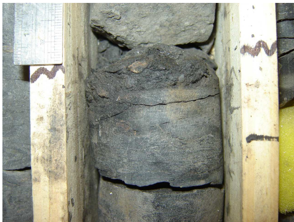
Figura 18 – Estrutura sedimentar erosiva interpretada como um Lag transgressivo que marca o limite basal de seqüência da seqüência deposicional “B3”, poço 4, prof. 99 m.
