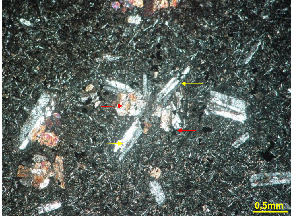
Figura 25 - Diabásio da região de Angra dos Reis com textura glomeroporfírica caracterizada por glomeropórfiros bifásicos (augita ( setas vermelhas ) e plagioclásio ( setas pretas )). Nicóis cruzados. Amostra: AR-NF-07c.
