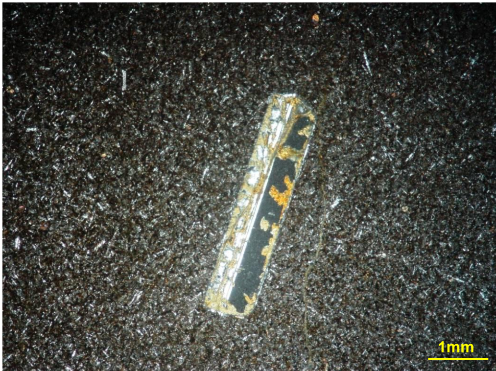
Figura 36 - Diabásio da região de Mangaratiba com fenocrystal de plagioclásio euédrico com zonamento composicional e corrosão interna ao grão. Nicóis cruzados. Amostra: MA-NF-21a.
