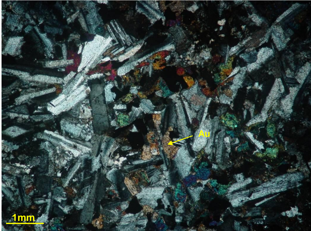
Figura 22 - Diabásio da região de Cunhambebe com textura holocristalina, intergranular com augita intersticial. Nicóis cruzados. Amostra: CB-NF-04.
