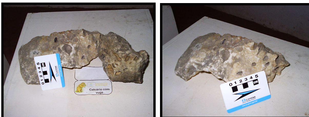
Figura 8.3: Calcário contendo cavidades denominadas “vugs” formadas por dissolução do calcário. Foto: BAPTISTA, A.C.S., 2008
