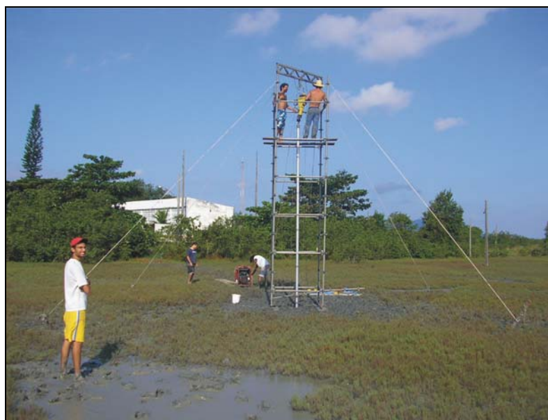
Figura 14. Coleta do testemunho com o testemunhador de percussão de alta frequência, campo de S. gaudichaudiana . Ao fundo uma antiga sede Rede Nacional de Estações Costeiras (Renec) – Embratel (foto: Gustavo de Araújo Carvalho, 15 de maio de 2008).
