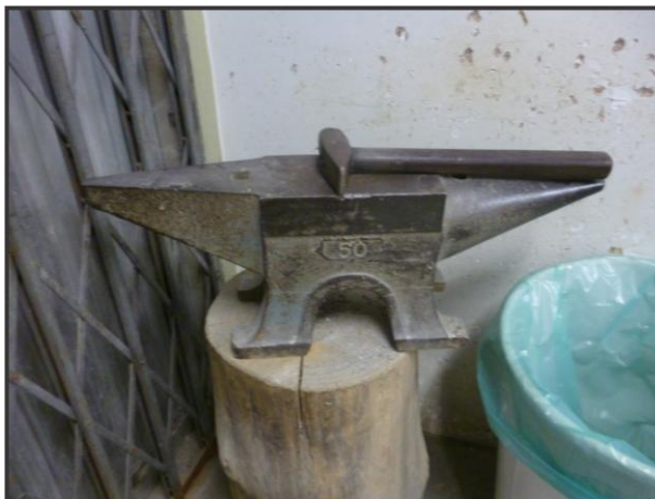
Figura A1 - Foto da bigorna e da marreta utilizadas na etapa de britagem manual pela aluna.
