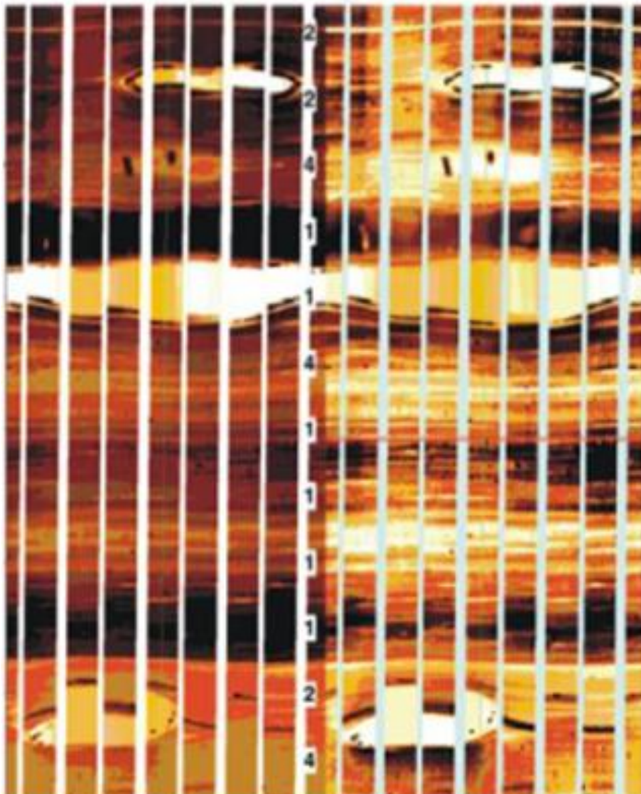
Figura 26 – Exemplo de registro de perfil de imagem resistiva de folhelho fraturado.
