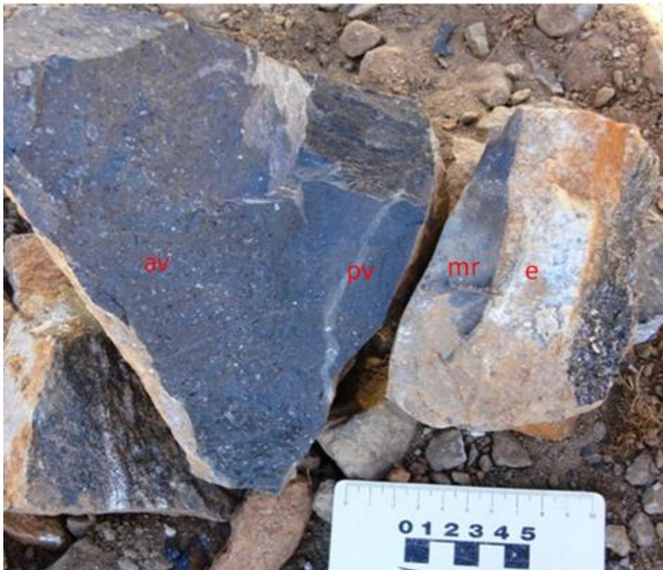
Figura 15 - Blocos mostrando contato entre gnaiss encaixante (e) e dique de lamprófiro. As concentrações de vesículas variam de acordo com a proximidade do contato: pouca vesiculação (pv) e margem resfriada (mr) próximo ao contato e alta vesiculação (av) longe do contato. Ponto: AGN-GM-03a e b.
