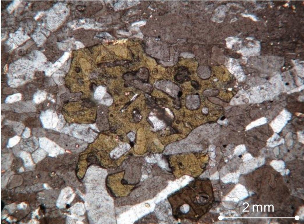
Figura 35 - Textura esquelética configurada pela corrosão interna do fenocristal de anfibólio sódico. Nicóis cruzados. Amostra: ITB-GM-01.
