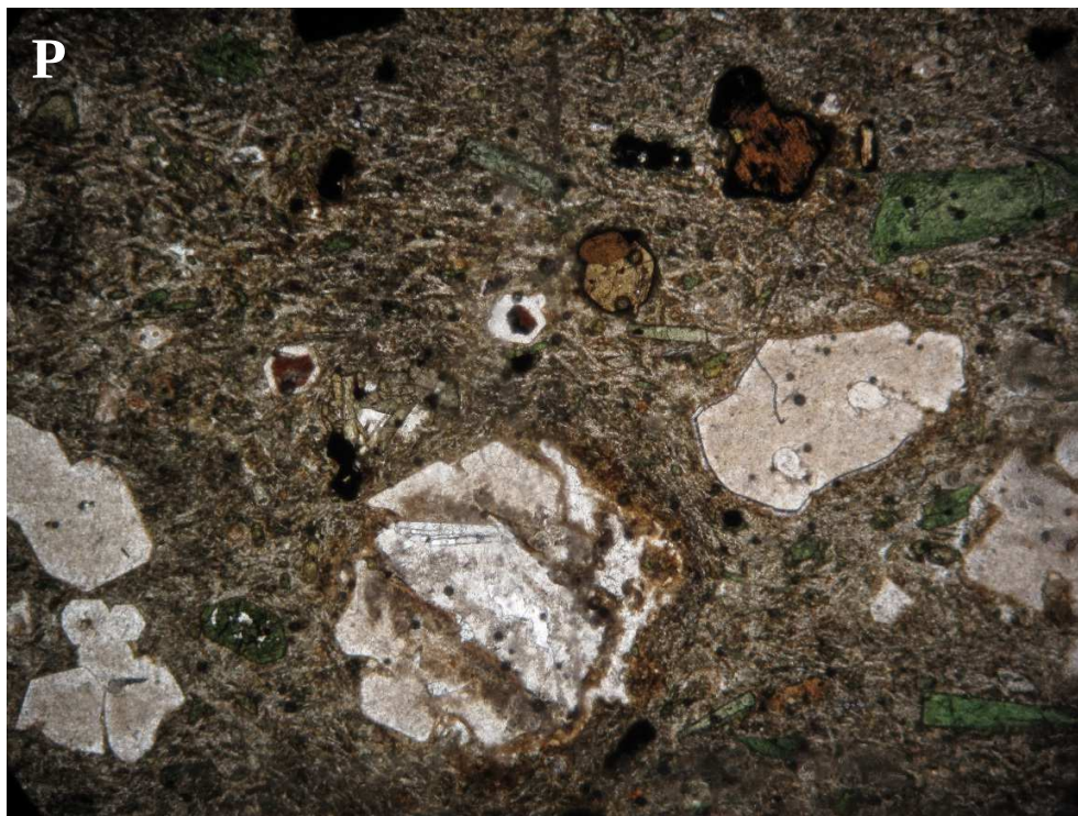
Figura 28 - Fotomicrografia da amostra MVA-05A. Ambas com aumento de 2,5X. A: nicóis cruzados e B: nicóis paralelos. Fenocristais de aegirina-augita, noseana zeolitizada e com fraturas preenchidas por carbonatos e kaersutita.
