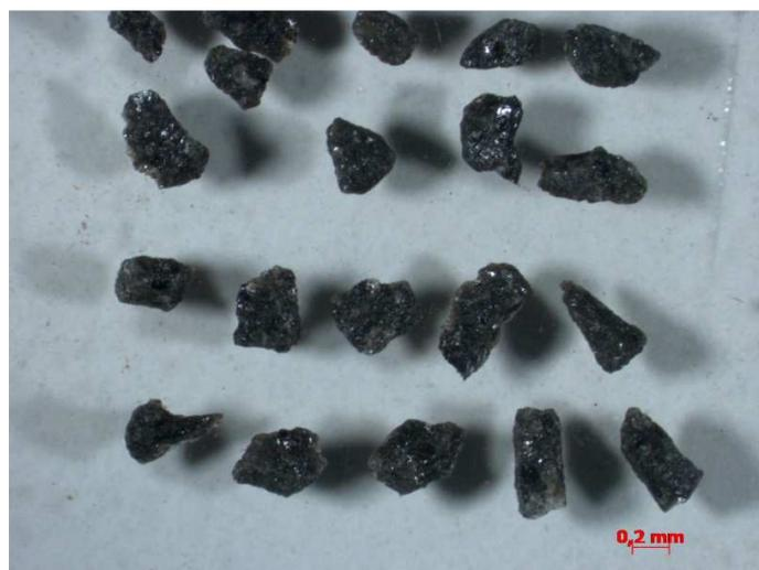
Figura 41 - Grãos da amostra MVA-04 contendo 1,25% em peso de  $\text{K}_2\text{O}$ .
