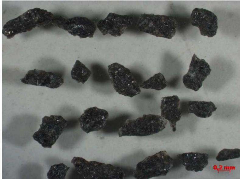
Figura 45 - Grãos da amostra MVA-07 contendo 1,48% em peso de  $K_2O$ .
